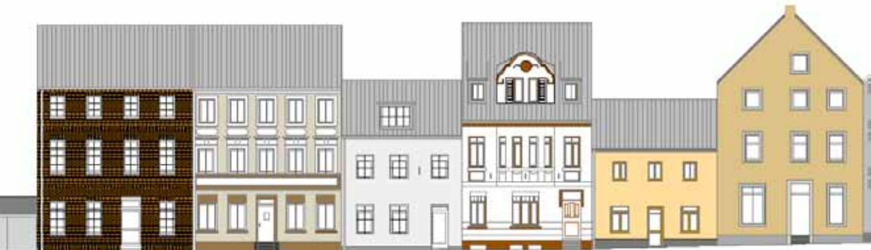
Haus Nr.15 Klinkerfassade
